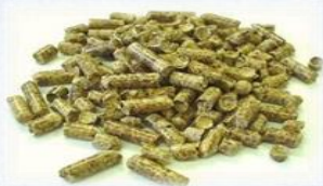
木質ペレット：おが粉などを圧縮成型して作る固形燃料
