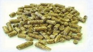
木質ペレット：おが粉などを圧縮成型して作る固形燃料
