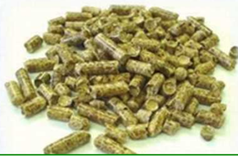
木質ペレット：おが粉などを圧縮成型して作る固形燃料
